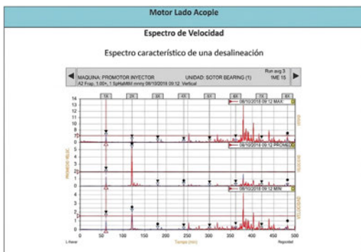
Figura 5. Espectro de velocidad del motor lado acople; se muestra un espectro característico de una desalineación.
