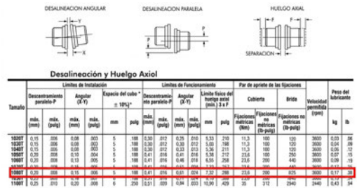
Figura 3. Límites de funcionamiento del acoplamiento utilizado.
